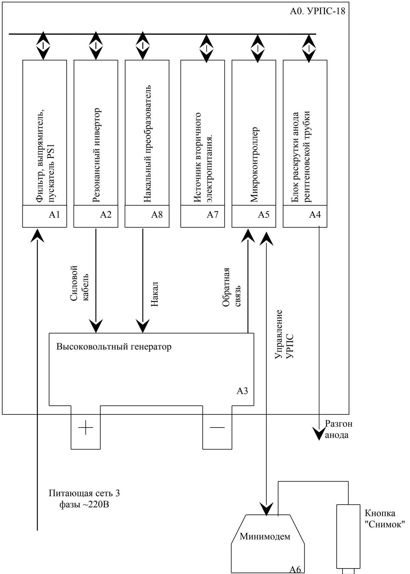
Рисунок 1. Функциональная схема УРПС-18.
